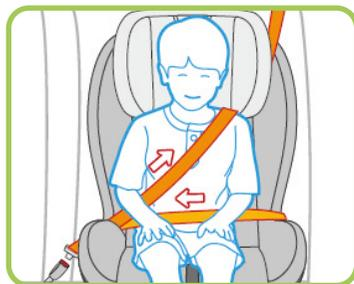
Po upevnění autosedačky k sedačce auta položte dítě do autosedačky, přetáhněte ramenní a bederní pás, tak jak je znázorněno na obrázku a upevněte bezpečnostní pásy.
