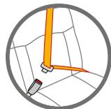
Просим обратить внимание на специальные правила применяемые в Вашей стране. Ремни используемые для фиксации автомобильного кресла должны быть произведены согласно регулированию ECE 16 либо с подобным равнозначным стандартом (ремни должны быть обозначены символом «E» либо «e» в колесе)
