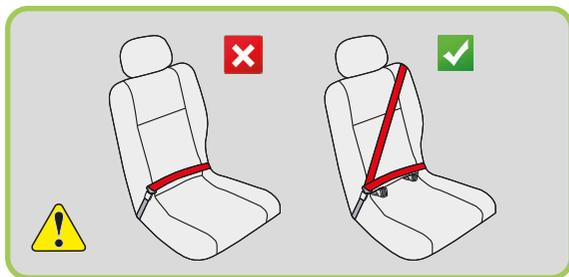
Ten fotelik jest przeznaczony dla dzieci w wieku od 2 do 12 lat i przystosowany do montażu za pomocą 3-punktowego pasa bezpieczeństwa wraz z opcjonalnym mocowaniem za pomocą systemu ISOFIX. W żadnym wypadku nie wolno stosować tego fotelika w samochodach wyposażonych w 2-punktowe pasy bezpieczeństwa.
