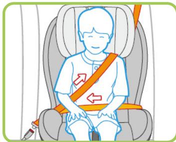
Po upevnení autosedačky k sedačke auta položte dieťa do autosedačky, pretiahnite ramenný a bedrový pás, tak ako je znázornené na obrázku a upevnite bezpečnostné pásy. Správne upevnenie pásov je zásadné pre bezpečnosť dieťaťa.
